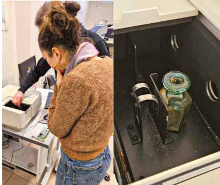
Utilisation du spectrophotomètre UV-visible sur le flacon.
